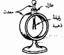
شكل ١٦ - ٤ أحد أشكال المكشاف الكهربى ( الالكترولوسكوب ) ذى الورقة الذهبية . يتكون الجزء المركزى من كرة معدنية ، قضيب معدنى وأوراق من رقائق الذهب ، وهذا الجزء معزول عن العلة .
